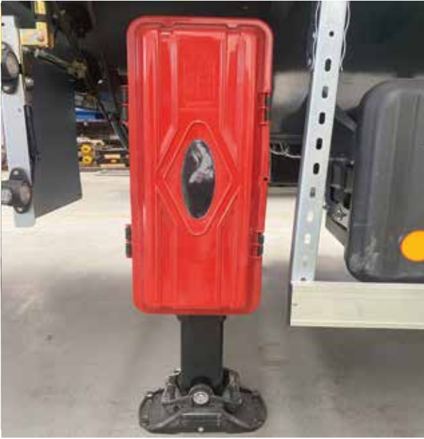
Yangın söndürme tüpü dolabı
