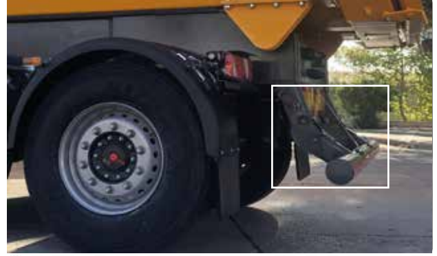
Kalkar tamponun kaldırılması
