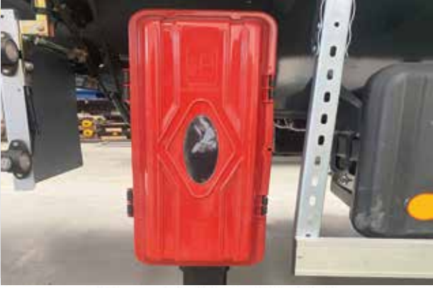
Yangın söndürme tüpü dolabı
